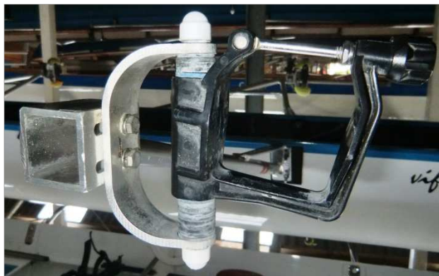
Dol met aluminium klemsysteem
