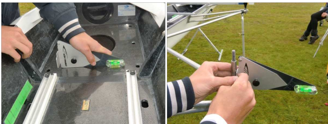
Links het ijkten van de dolhoekmeter, rechts het opmeten van de buitenwaartse dolpenhoek
