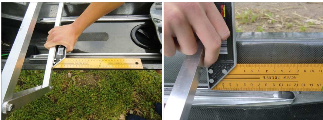
Het meten van de door het werk stand met dolhoogtemeter en haakse hoek
