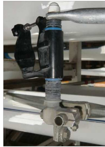
Links de standaard dol met standaard stelsysteem, rechts het Verschoor stelsysteem in de variant met buitenhoek verstelling
