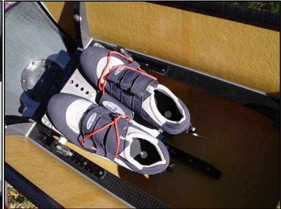
Het voetenbord kan in hoogte worden versteld
