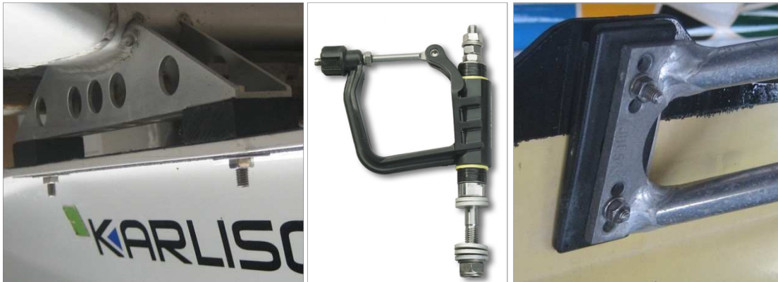
De verschillende manieren om de dolhoogte te verstellen op een rij
