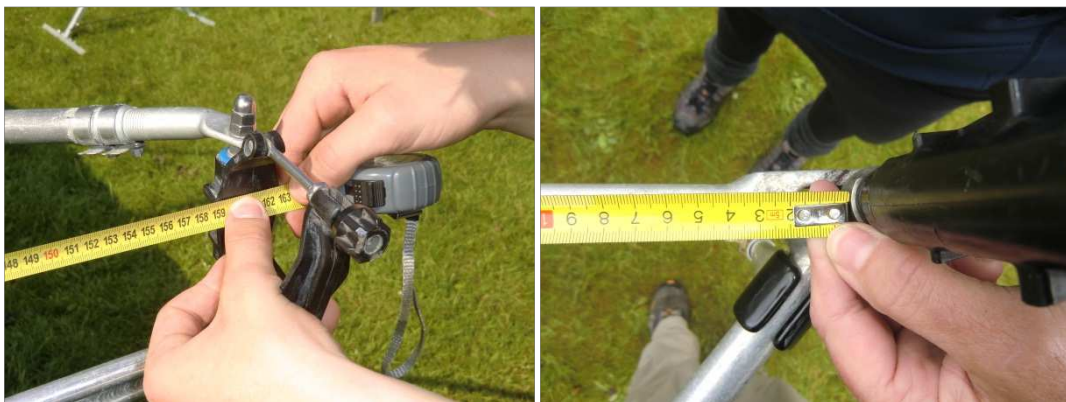
Links, het span gemeten van dol tot dol. Rechts het opmeten van de afstand vanaf de onderzijde van de dol tot aan de boordrand.
