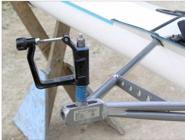
Links de standaard dol met standaard stelsysteem, rechts het Verschoor stelsysteem in de variant met buitenhoek verstelling
